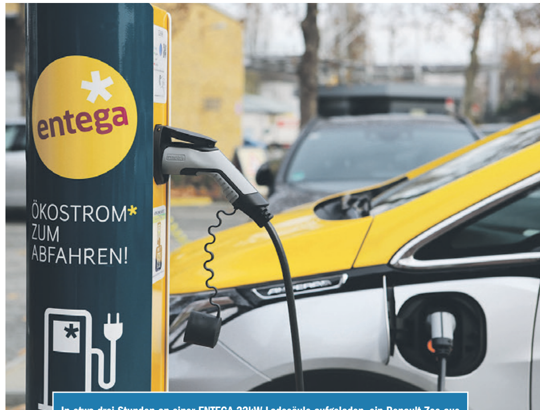
In etwa drei Stunden an einer ENTEGA-22kW-Ladesäule aufgeladen, ein Renault Zoe aus dem E-Carsharing-Angebot für Kommunen. Foto: ENTEGA
