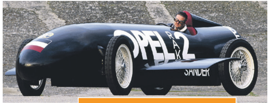
Der Opel RAK2 ist ein raketengetriebenes Fahrzeug.
