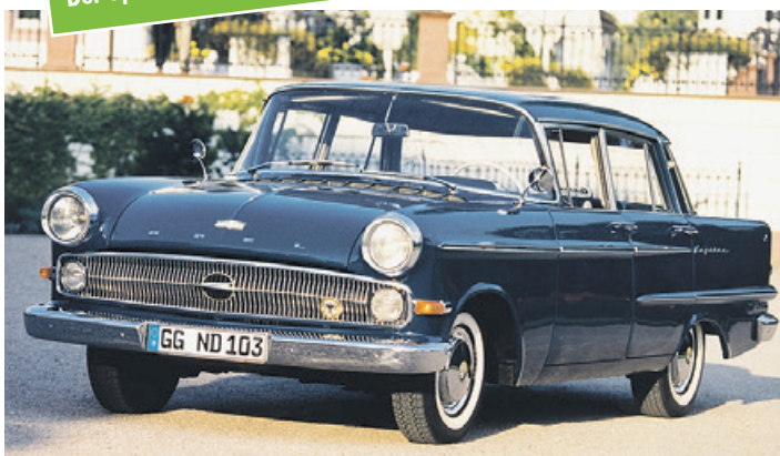
Der Opel Kapitän P2, 1959-1964 wurde der erfolgreichste Kapitän, der je gebaut wurde. Nach dem bis Mitte 1960 verwendeten Overdrive bot Opel bei diesem Modell ab Sommer 1960 erstmals als Extra ein automatisches 3-Gang-„Hydramatic“-Getriebe und ab 1962 eine Servolenkung an
